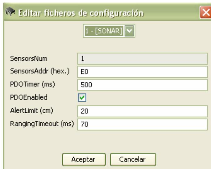
Figura 7: Editor de los ficheros de configuración de los nodos
