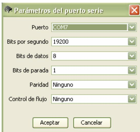
Figura 3: Configuración del puerto serie en Windows
