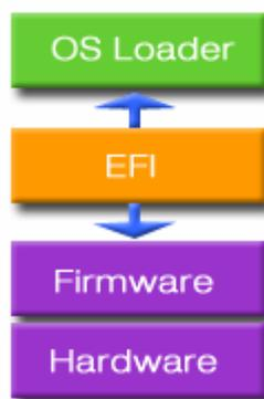
Ilustración 4 – Diagrama de bloques de la especificación EFI
