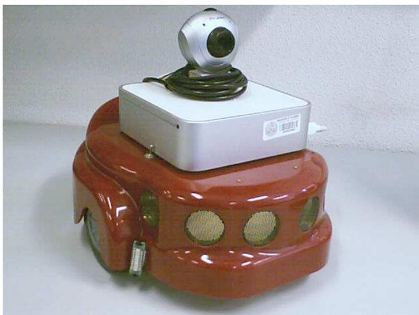
Figura 1 – Robot AmigoBot con el *Mac mini* y la cámara web instalados
