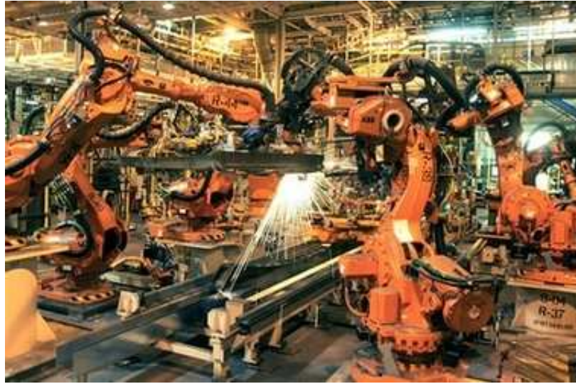
Figura 1.1: Robots soldadores en la planta de ensamblaje de Chrysler en Windsor, Canadá.
