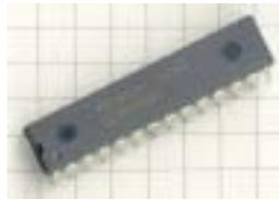
Figura 4.19: Microcontrolador PIC 16F876
