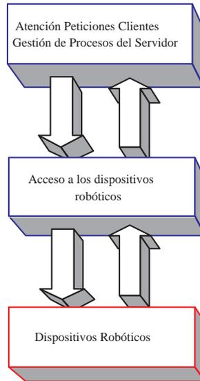
Figura 3.2: Capas de la Arquitectura del Servidor
