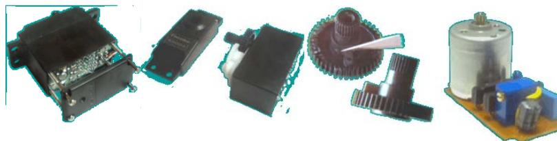
Figura 3.4: Etapas para el trucaje de un servo
