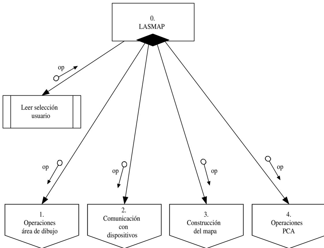
Figura 2.1: Diagrama de estructuras: módulo inicial
