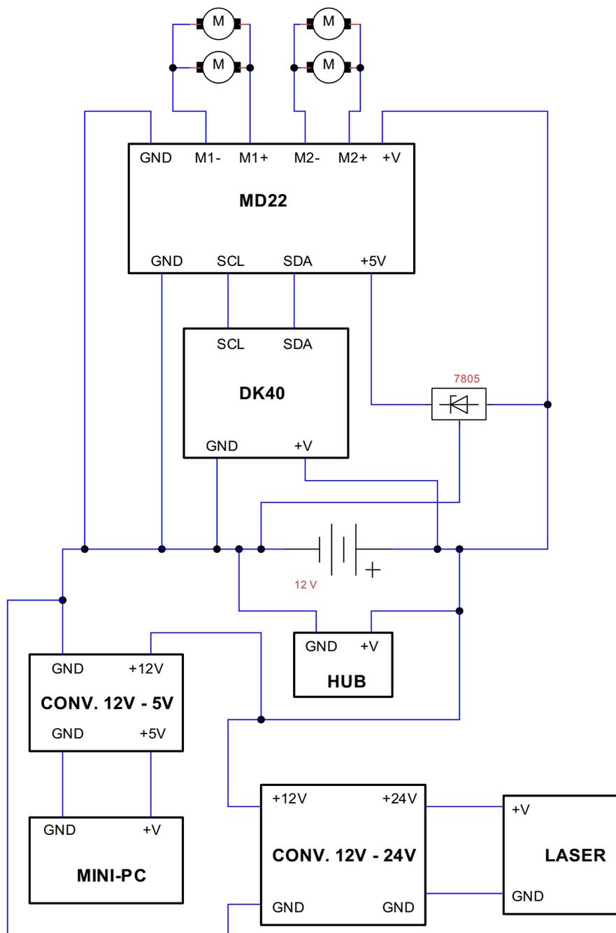
Figura 3.1: Esquema eléctrico de las conexiones del robot
