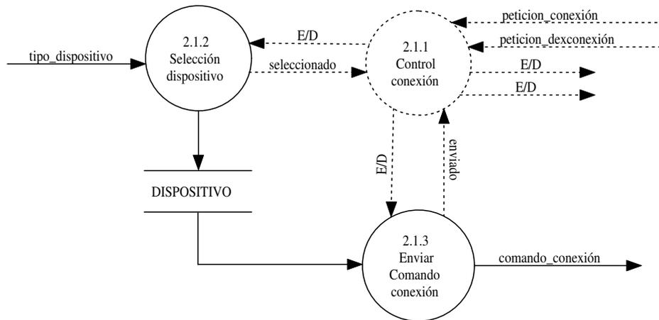
Figura 3.5: Explosión del proceso 2.1. Conexión de dispositivos.
