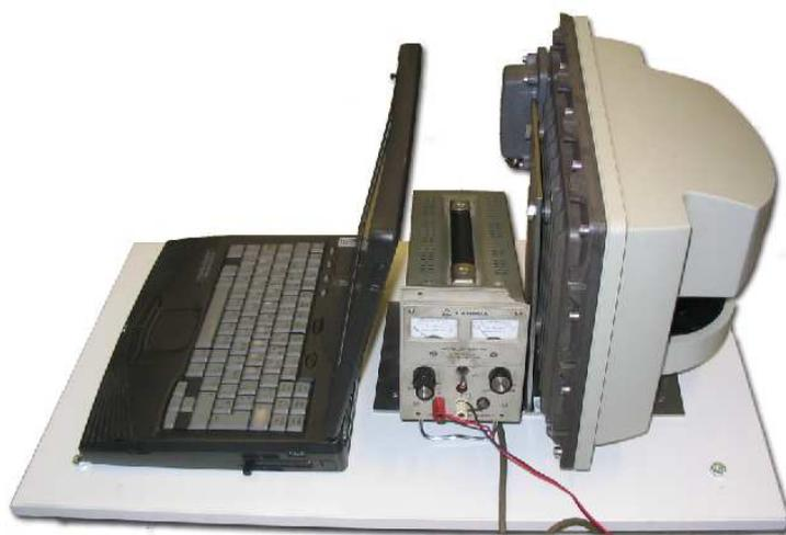
**Figura 2.8:** *Primera plataforma para el escáner láser*
