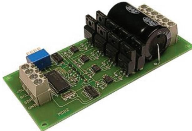
**Figura 3.2:** Controlador de motores MD22
