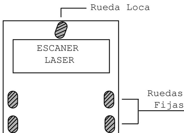
**Figura 2.10:** Configuración diferencial de las ruedas
