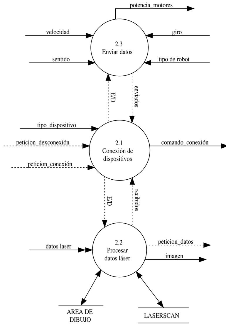
Figura 3.2: Explosión del proceso 2. Comunicación con dispositivos.
