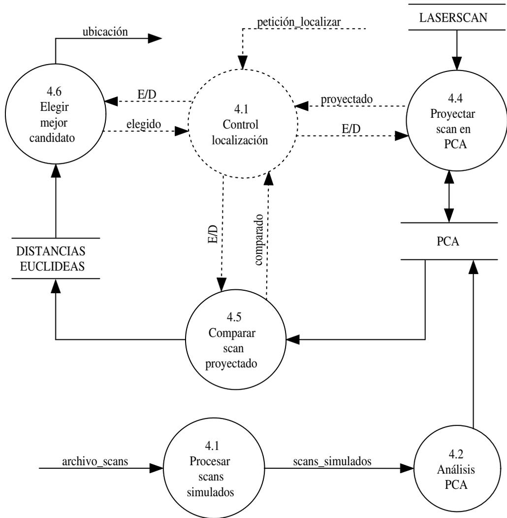
Figura 3.4: Explosión del proceso 4. Operaciones PCA.
