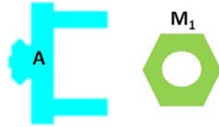
Figura 4.2: Escenario básico con una pinza de dedos paralelos y un objeto (una tuerca) a manipular.
