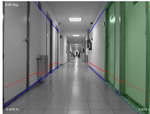
Figura 5.3.10: Resultado de la detección de puertas: en la pared derecha se han efectuado dos detecciones, mientras que en la pared izquierda no se ha podido detectar ninguna puerta.
