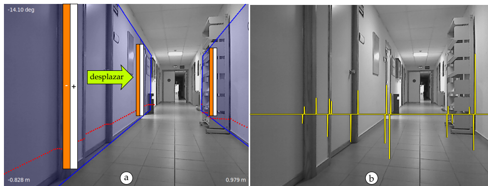
Figura 5.1.4: a) Búsqueda de cambios de intensidad verticales en la imagen utilizando ventanas deslizantes a lo largo de las regiones de interés. b) Resultado de aplicar las ventanas deslizantes a la imagen.
