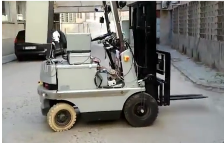
Figura 5.11: Carretilla navegando de forma autónoma con nuestro RDE integrado
