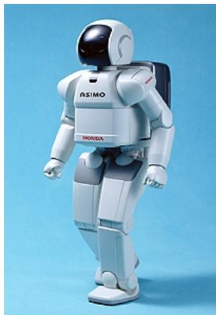
Figura 1.3: Robot humanoide redundante con 26 grados de libertad
