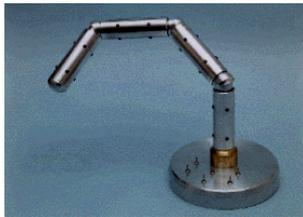
Figura 1.1: Robot redundante tipo serpiente
