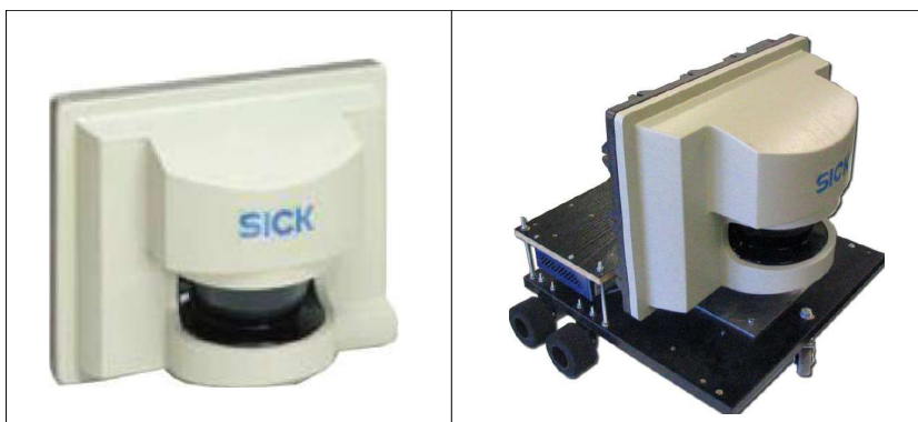
Figura 1.1: Escáner láser sick lms 221 (en la derecha, montado en el robot móvil)
