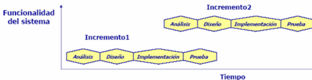
Figura 47: Proceso iterativo e incremental
